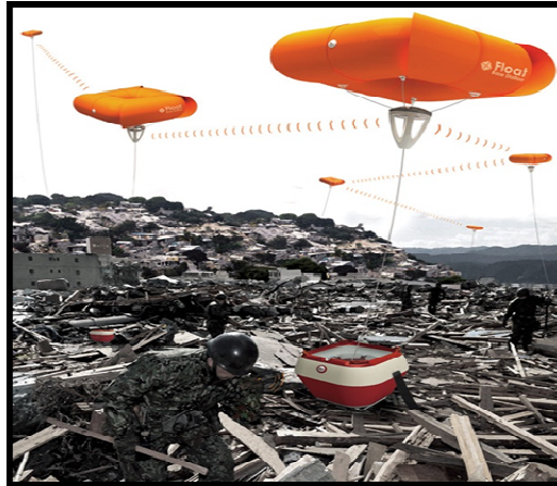
شكل (١١) محطة الاتصال Float Base Station في وضع الاستخدام
